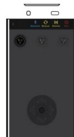
**Экран калибровки:** калибровка требуется в случае отклонений положения камеры по всем трем осям. Нажмите «Начать калибровку» и выполните процедуру шестисторонней калибровки, следуя подсказкам-иллюстрациям на экране.
