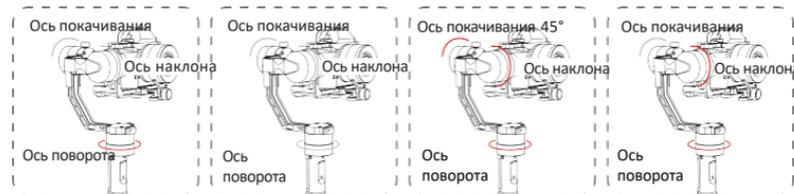
**Панорамный режим слежения:** камера поворачивается влево/вправо, следуя движениям стабилизатора, оси наклона и покачивания заблокированы. Ось наклона управляется вручную движением джойстика вверх/вниз.
