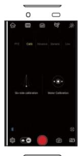
**Экран управления:** Позволяет использовать различные элементы управления стабилизатором, включая изменение режимов работы и управление перемещением по соответствующим осям.
