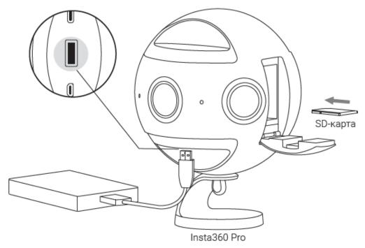
Примечание: После того, как камера получит доступ к внешнему жесткому диску с USB 3.0-интерфейсом, внешний жесткий диск становится устройством хранения по умолчанию для файлов съемки.
