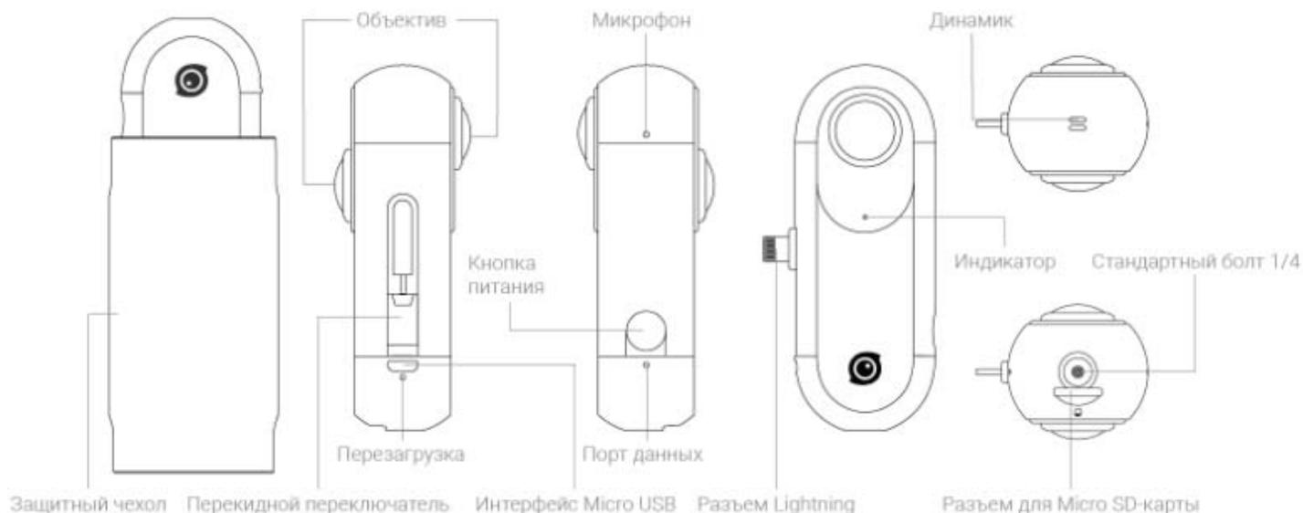
**01.** Перед использованием камеры достаньте ее из защитного чехла. Сдвиньте перекидной переключатель и установите коннектор Lightning в положение, указанное на рисунке ниже. После использования камеры необходимо с помощью перекидного переключателя убрать коннектор обратно и затем поместить камеру в защитный чехол, чтобы не предотвратить механические повреждения.
