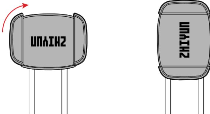
4. Всегда устанавливайте смартфон таким образом, чтобы камера была с левой стороны держателя. Затем выполните балансировку для съемки в горизонтальном или портретном режиме. Для этого передвигайте смартфон в держателе влево или вправо до тех пор, пока смартфон не будет находиться в сбалансированном положении.
