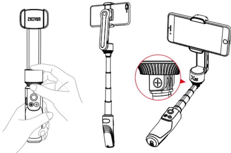
Максимальный диапазон перемещения оси наклона составляет  $90^{\circ}$ . Превышение этого значения приведет к поломке SMOOTH-XS. Если крепление оси наклона ослабло, затяните крепящий ее винт с помощью крестообразной отвертки.
