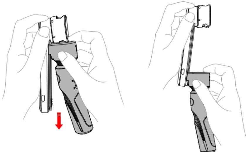
**⚠** Перед включением и использованием стабилизатора разверните SMOOTH-XS и обеспечьте контакт с контактной группой.
