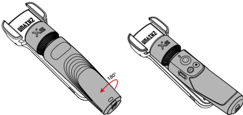
2. Чтобы обеспечить контакт с контактной группой, потяните мотор оси панорамирования к нижней части вертикального рычага, удерживая моторы оси крена и оси панорамирования, до щелчка.
