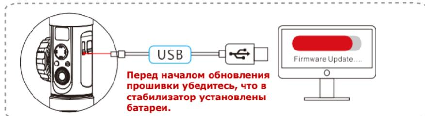
Подключите стабилизатор к компьютеру с помощью кабеля Micro USB при подготовке к обновлению прошивки.
