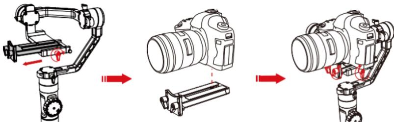
2. Установите объектив на быстросъемную площадку, затем затяните снизу винт с резьбой 1/4" (как показано на рисунке).
